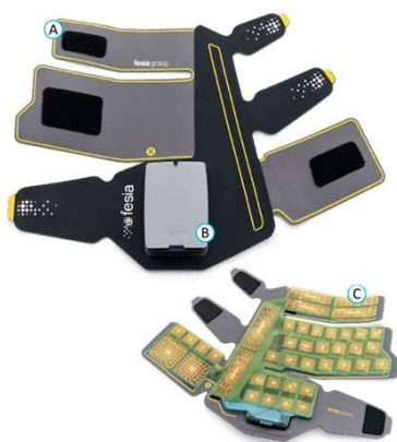
Figura 1: Componentes del dispositivo Fesia Grasp. A) Textil. B) Estimulador. C) Electrodo multi campo.
